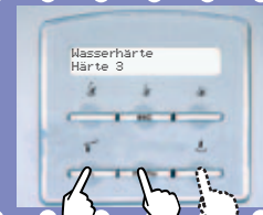
Entsprechenden Härtegrad auswählen (z.B. 2 Quadrate = Härte 2) und mit der Menü-Taste speichern.
